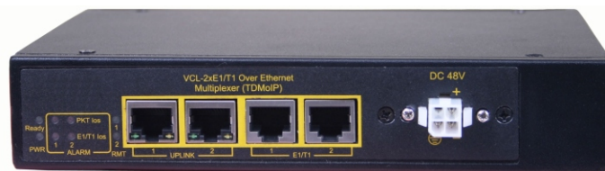
VCL-2 x E1 over Ethernet Multiplexer (TDMoIP)
