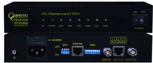
VCL-Ethernet over E1 (FE1)
